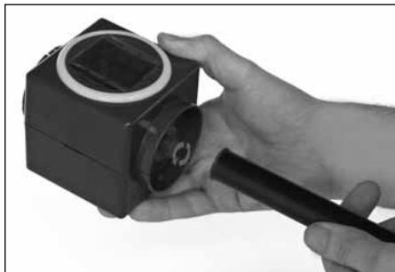
Enrosca a estaca no fundo do cubo e coloca-a numa área aberta ao ar livre. Certifica-se de que a extremidade está bem inserida no solo.
