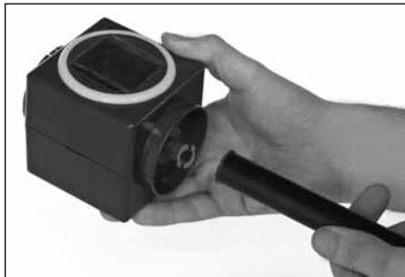
Schroef de stok aan de bodem van het pakket vast en plaats deze buiten in het vrije veld. Zorg ervoor dat de punt van de stok goed vast in de grond staat.
