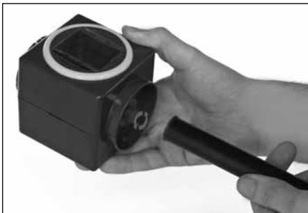
Schraube den Erdspieß an den Boden des Würfels und platziere ihn in einem offenen Bereich im Freien. Stelle sicher, dass die Spitze fest in den Boden eingesetzt ist.
